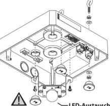
Aus Gründen der elektronischen Sicherheit sowie der Dichtigkeit sind die Verschlussstopfen unbedingt zu montieren!
