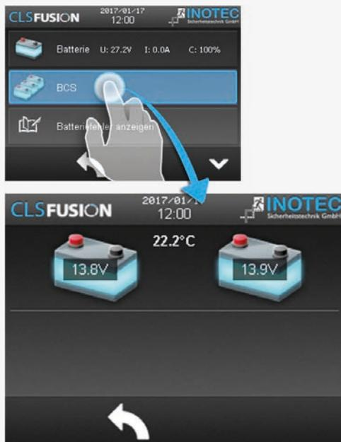
Die Sensoren sind in separaten Spalten mit aktuellen Werten der zu überwachenden Batterieblöcke dargestellt. Hier sind Daten zur Blockspannung und der Temperatur aufgeführt. Links und rechts neben dem Batteriepaar befinden sich zwei farbige Striche, diese geben der jeweiligen Batterie Ihre Farbzugehörigkeit.
