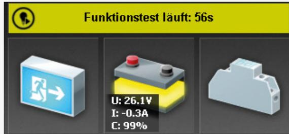
Im Funktionstestmodus schaltet das Gerät in den Batteriebetrieb und überprüft die angemeldeten Leuchten auf deren Funktionstüchtigkeit. Das Ergebnis des Funktionstest wird im Prüfbuch abgespeichert. Der aktuelle Status wird in der „Statusanzeige“ im Hauptmenü angezeigt. Sofern eine Leuchtenstörung vorliegt, wird diese als Störung angezeigt. Die Statusanzeige sowie das Leuchtensymbol wechselt in den roten Farbmodus.
