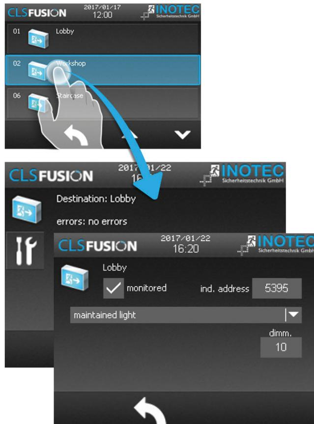
In diesem Untermenü werden einzelne Leuchten eines Stromkreises untereinander dargestellt. Durch Anwählen der Leuchtensymbole gelangen Sie in die unterste Leuchtenebene, die Detailansicht. Hier können detaillierte Informationen zum Status der Leuchte ausgelesen werden. Ist ein Zielort vergeben wird dieser im Anzeigefeld „Zielort“ dargestellt. In dem darunter angeordnetem Bereich ist die Adresse des Moduls zu sehen.
