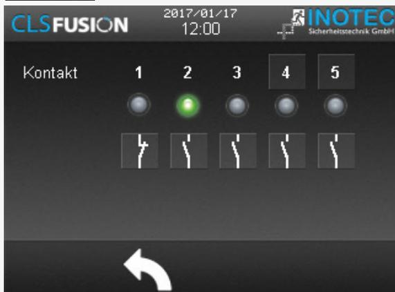
Bei den ersten drei LED's wird der Anlagenstatus angezeigt. Das Relaisinterface ist vom Werk aus einprogrammiert. Die Meldungen der ersten drei Relaiskontakte sind fest eingestellt (Störung, Betrieb, Batterie-Betrieb). Unterhalb der Leuchten befinden sich Checkboxes, hier kann zwischen Öffner und Schließer ausgewählt werden.
