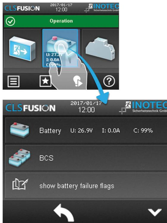
**!** Bei der Inbetriebnahme der CLS FUSION, wird die Prozentangabe der Batteriekapazität im ersten Moment mit einem "?" dargestellt. Das Fragezeichen bedeutet, dass der Wert noch nicht ermittelt wurde. Dieser Vorgang kann einige Stunden in Anspruch nehmen, bis der korrekte Prozentsatz der Batteriekapazität ermittelt ist.
