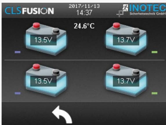
Mit einem Klick auf ein Batteriepaar gelangen Sie zu einem Diagramm, das einen kurzzeitigen Verlauf der Spannung visualisiert.
