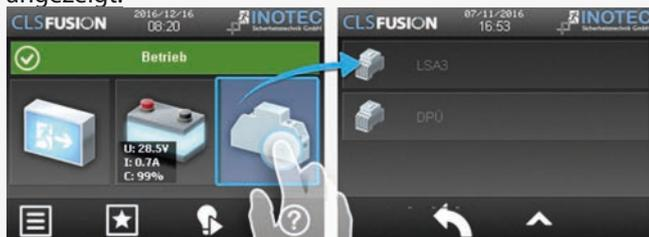
Nach Betätigen der Funktionsschaltfläche „Komponenten“ werden im Zuge von Untermenüs die dem System angebotenen DPÜ/B-Module und deren Standort angezeigt. Im Untermenü „DPÜ/B“ werden Module und deren ausgefallene Phase (n) die mit einer Störung behaftet ist (sind), durch rote LED's angezeigt.
