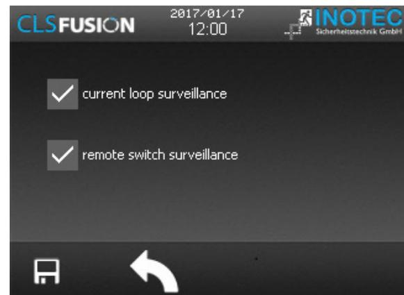
In diesem Untermenü werden folgende Detailinformationen zum SLÜ-Modul angezeigt. Die beiden Checkboxes zeigen die Aktivierung oder Deaktivierung der jeweiligen Überwachung an.
