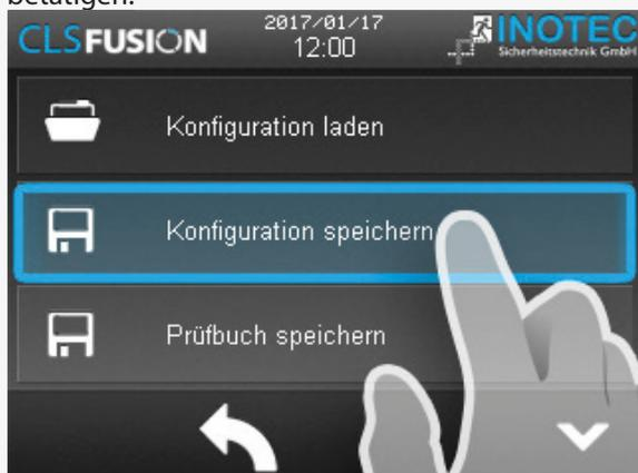
Die Konfigurationsdatei wird auf dem USB-Stick gespeichert. Der Dateiname ist Konfig\_CLS\_(datum)(Uhrzeit).cfg und kann mit der INOTEC Konfigurationssoftware bearbeitet und ausgedruckt werden. Sobald die Meldung „die Konfiguration wird gespeichert“ geschlossen wurde, kann das USB-Speichermedium entfernt werden.
