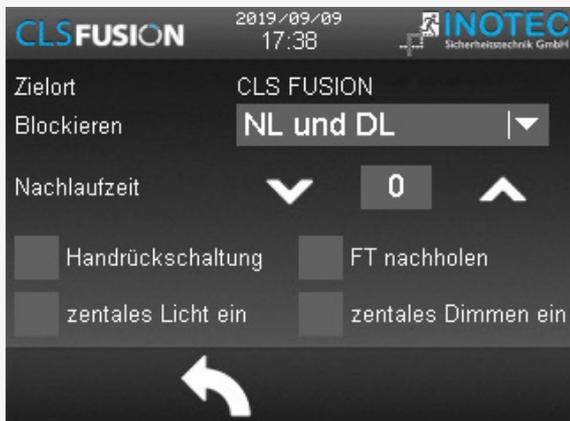
Hinweistext zu „FT nachholen“: Ist die CLS FUSION im Betriebszustand „blockiert“ und läuft zu diesem Zeitpunkt ein Funktionstest (FT) auf, darf die CLS FUSION den FT nicht ausführen. Mit der Aktivierung der Check-box „FT nachholen“, merkt sich die CLS FUSION, dass ein Funktionstest ausgeführt werden sollte und holt diesen, 10sec nach freigeben, automatisch nach.
