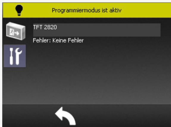
Grau hinterlegte Leuchten symbolisieren nicht angemeldete bzw. nicht aktivierte Leuchten. Über das Werkzeugsymbol gelangen Sie zur Anmeldung der verschiedenen Leuchtenklassen. Über einen Klick auf die hellgrau hinterlegte Schaltfläche (über „Fehler: Keine Fehler“) gelangen Sie zur Zielortvergabe.
