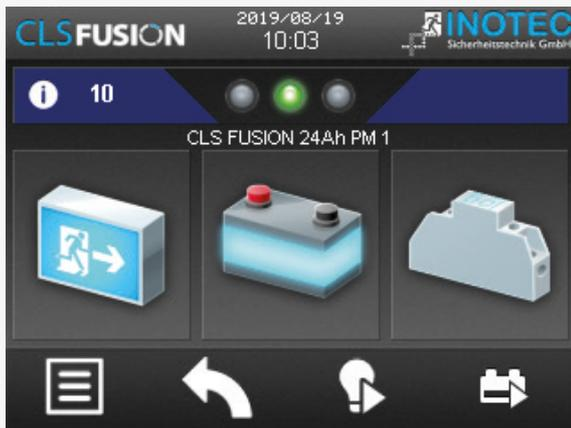
**!** Befindet Sie sich in der Detailansicht einer CLS FUSION Anlage, kann keine Leuchten, Geräte oder Modulprogrammierung gestartet werden. Diese Gerätespezifischen Veränderungen müssen immer direkt an der CLS FUSION Anlage vorgenommen werden.
