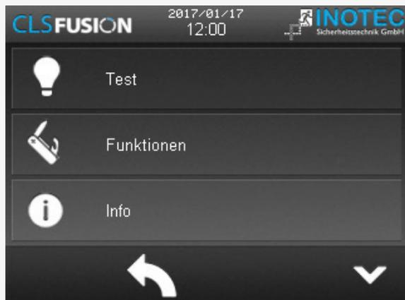
Hier stehen verschiedene Funktionen für die systematische Abfrage des Gerätezustandes, Testmöglichkeiten oder Einstellungen des Gerätes zur Verfügung. Konfigurationen sowie das Einsehen des Prüfbuches sind durch Aktivierung entsprechender Untermenüs möglich. Wird eine Einstellung verändert, müssen diese immer gespeichert oder verworfen werden. Die beiden Optionen tauchen automatisch auf. Zum speichern klicken Sie auf die Diskette und zum Verwerfen auf die Mülltonne.
