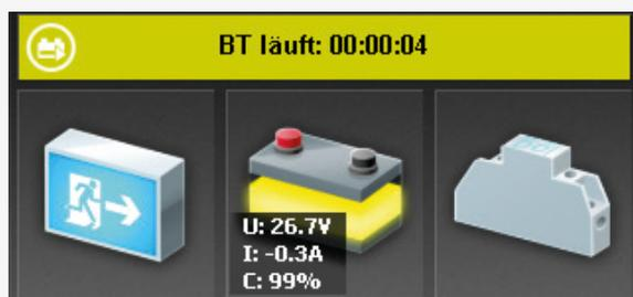
Nach Beendigung des BT-Test schaltet das Gerät wieder in den Betriebszustand. Durch Betätigen der Schaltfläche
